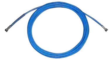
ШЛАНГ, ЗАЩИЩЁННЫЙ ОТ ПУЛЬСАЦИИ 1/4" - M16x1,5 давления max. 250 bar Артикул 35013: 5 mt Артикул 35014: 7,5 mt Артикул 35017: 10 mt Артикул 18026: 15 mt
